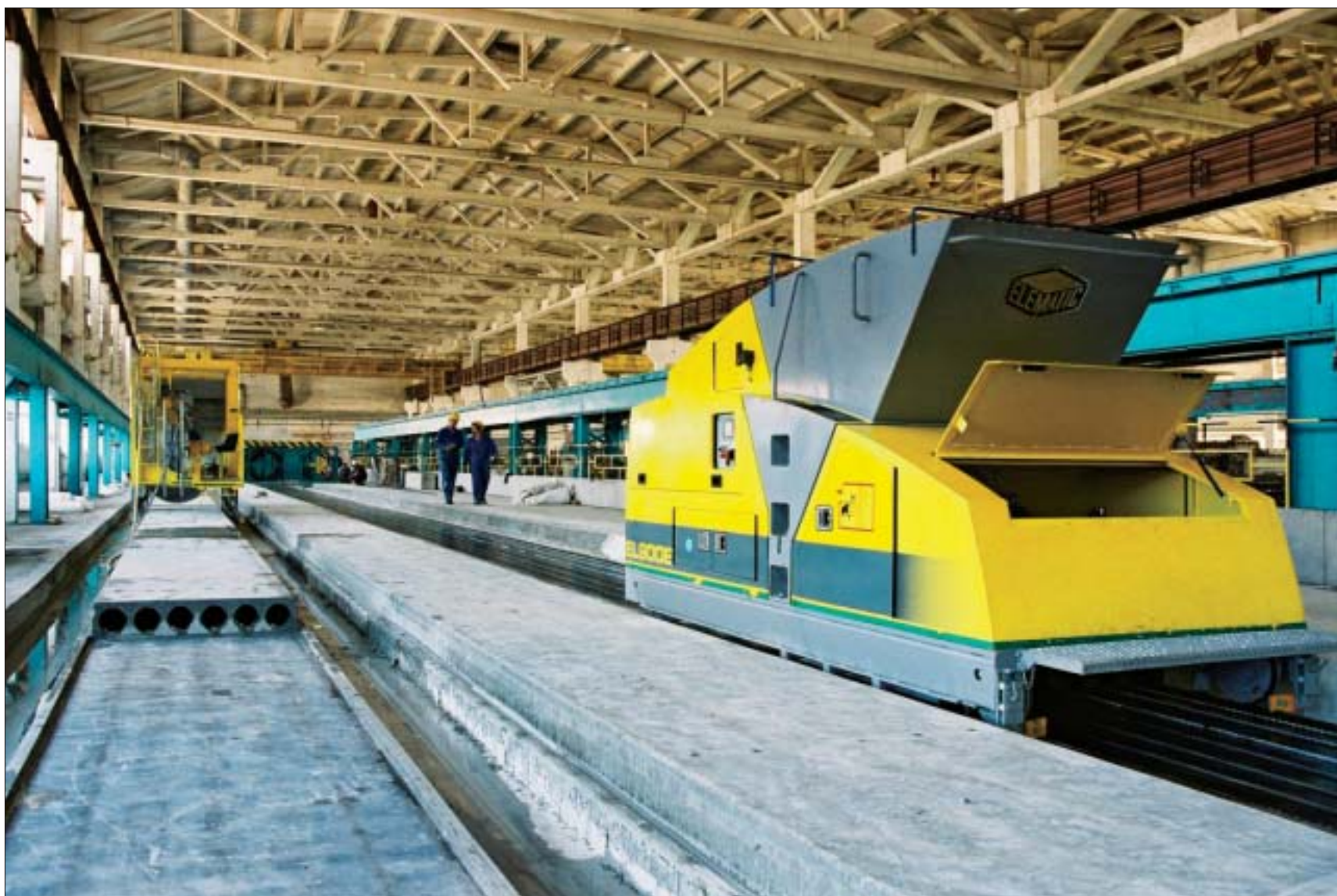
AS LASBET õõnespaneelide vormimisseade. Paremal asuv kollane masin vormib paneeli vajalikku mõõtu.
