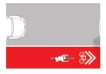
На дорогах с малой скоростью и частотой движения подходящими являются как делимые, так и рекомендованные участки. На участках с высокой скоростью и частотой движения следует взвесить планирование выделенного участка или отдельной дороги.
