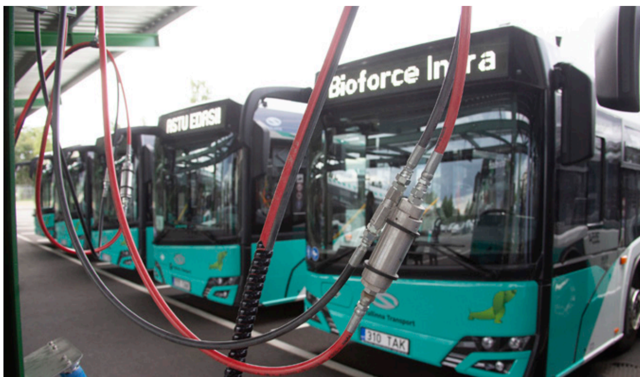
Современные таллинские автобусы на газе заправляются на крупнейшей в Балтийских странах станции сжатого газа. Фото: Альберт Труувяэрт
