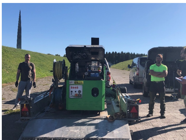
Kuuma veega umbrohu töötlemiseks kasutatavad masinad (F: K. Kupper)
