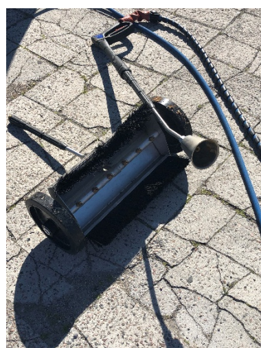
Umbrohu tõrjumisel on võimalik kasutada erineva suurusega otsikuid (F: K. Kupper)
